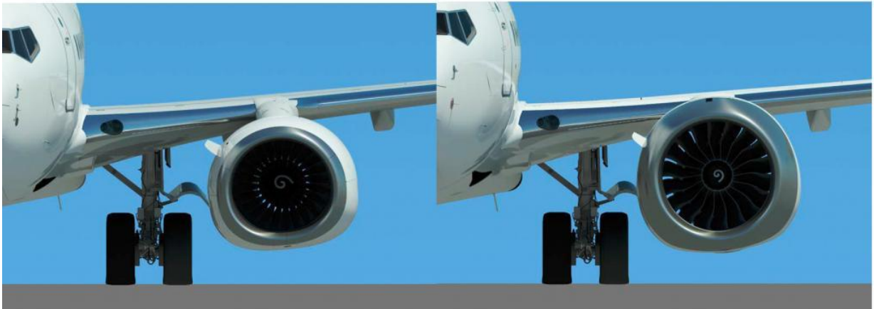
Figura 2: Boeing 737 NG e Boeing 737 MAX: Diferença nos motores
