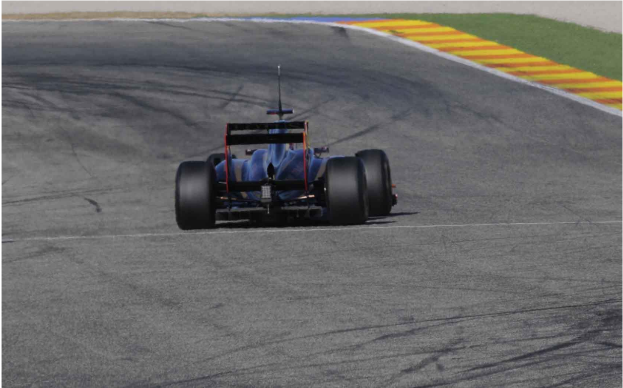
Figura 3 – Exemplo de aerofólio multi-elemento na Fórmula 1
