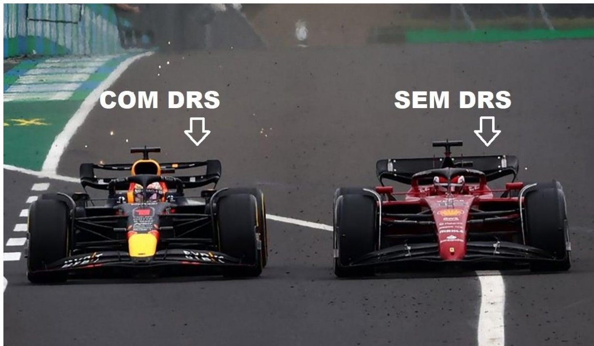
Figura 4 – Exemplo de aerofólio ativo em funcionamento
